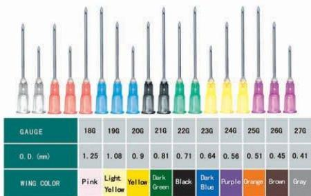
**AGULHAS DE SERINGA:** São utilizadas nas pontas das colas de cianocrilato para uma aplicação mais precisa, quando entopem, basta esquentar o bico da agulha com um isqueiro para derreter a cola seca do bico e liberar o fluxo de cola novamente. São descartáveis e quando entopem definitivamente devem ser trocadas. Se forem retiradas da cola, devem ser trocadas por outra nova. Aumentem o diâmetro da agulha de acordo com a viscosidade da cola. (A venda em lojas de produtos cirurgicos)
